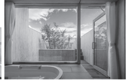
テラス付の浴室。高低差と木柵と植栽でプライバシーと開放感を確保
