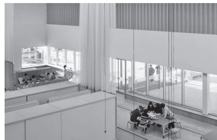
カーテンと吸音壁で音環境を制御。様々な活動が共存できる
