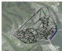
①自噴する湧水の位置をプロットし、ドローン三角分割を行い、湧水の疎密の関係性を探る。
